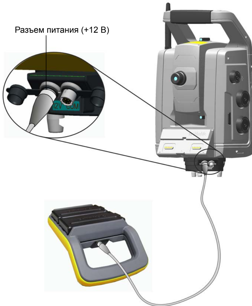
Рисунок 6.2. Подключение адаптера для нескольких батарей
