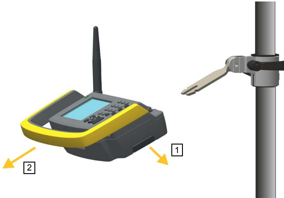
Рисунок 6.24. Отсоединение держателя Trimble Robotic с адаптера стандартной вехи
