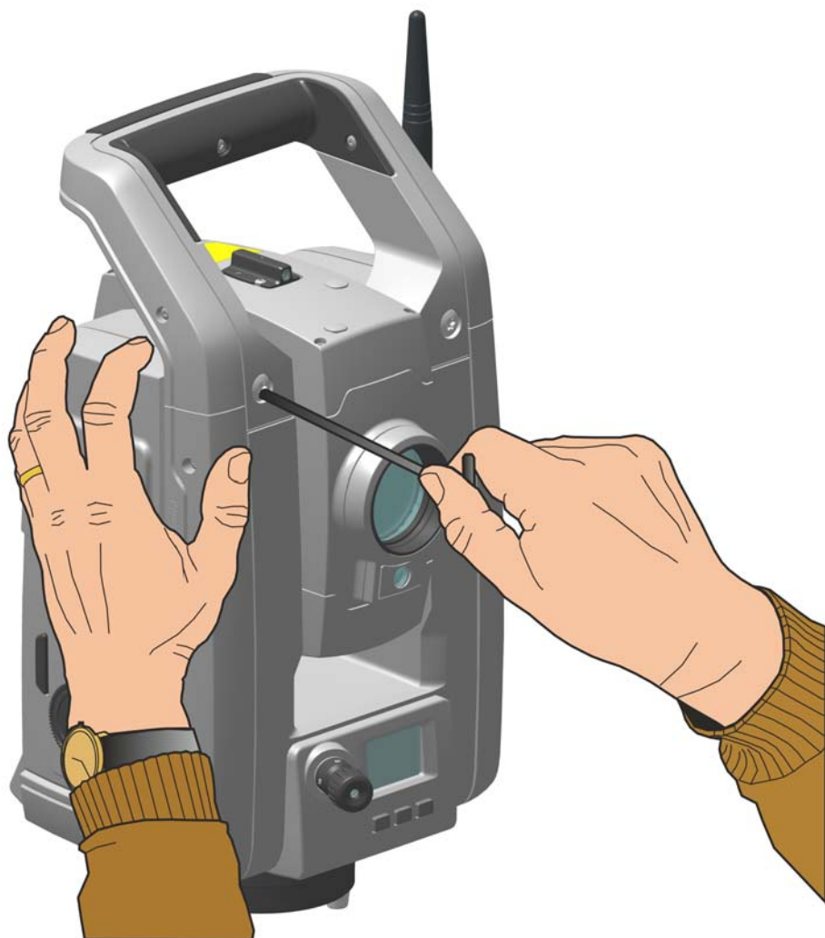
Рисунок 3.13. Отсоединение ручки инструмента
