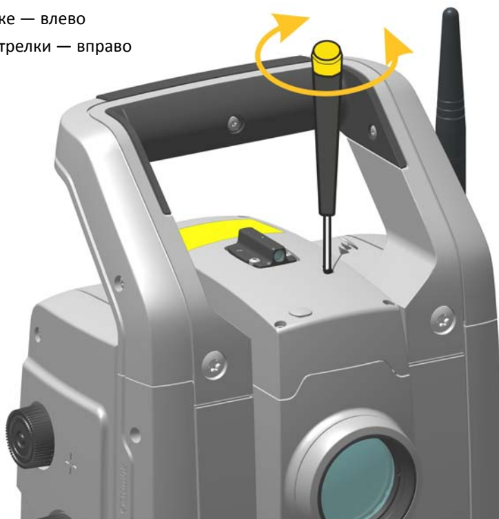
Рисунок 4.7. Юстировка положения лазерного указателя по горизонтали
