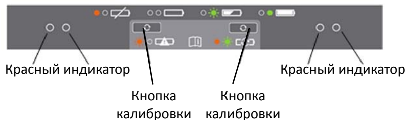
Рисунок 3.6. Панель управления зарядного устройства на две батареи
