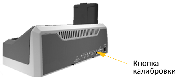
Рисунок 3.4. Кнопка калибровки на зарядном устройстве
