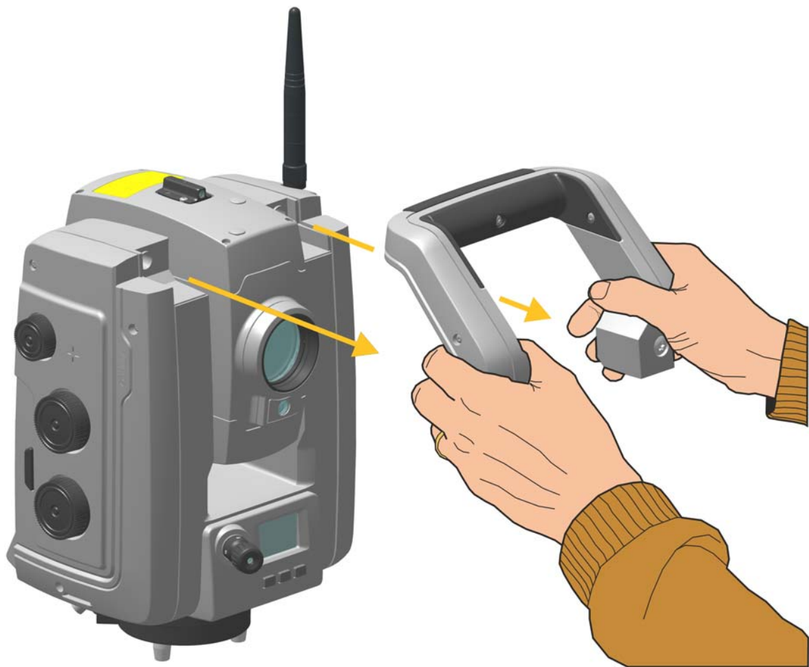
Рисунок 3.14. Отсоединение ручки инструмента
