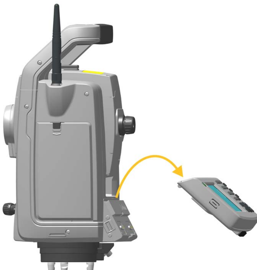
Рисунок 4.15. Снятие TCU с инструмента
