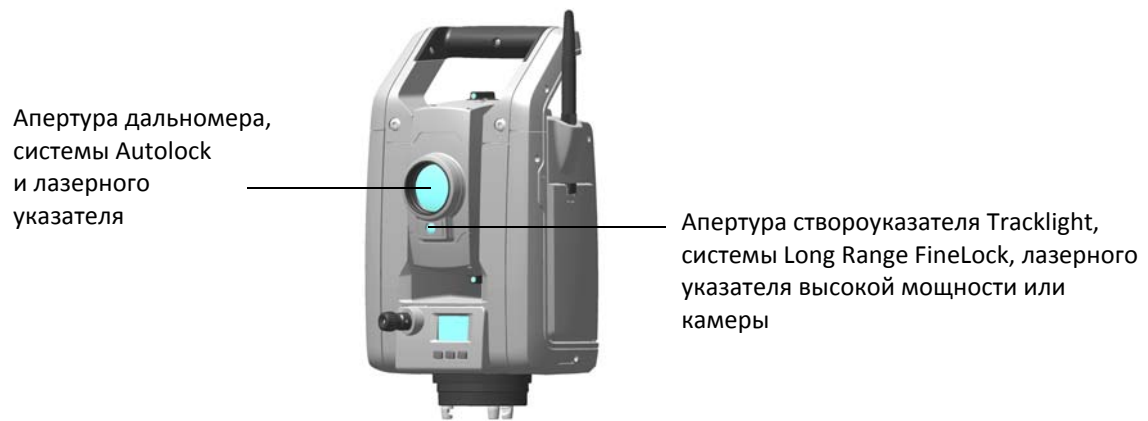
Рисунок 1.1. Апертуры тахеометра Trimble S9
